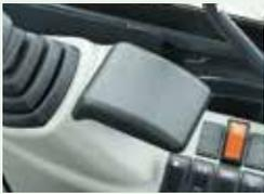
Les repose-poignets ajustables des manipulateurs soulagent les épaules et avant-bras.
