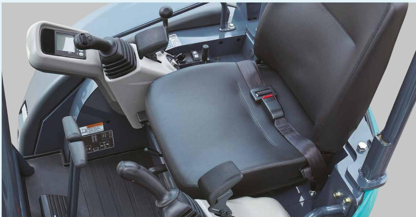
Le vaste plancher associé au siège coulissant offrent plus de place pour les jambes des plus grands. Le large siège suspendu et inclinable, ainsi que le positionnement des manipulateurs offrent un confort de travail exceptionnel.
