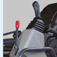
Le levier de verrouillage de sécurité n'autorise l'entrée et la sortie que quand les manipulateurs sont neutralisés, évitant tout mouvement intempestif.
