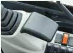
Handgelenkstützen an beiden Steuerhebelkästen sorgen für ein ermüdungsfreies Arbeiten.
