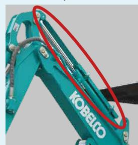
Schutz des Löffelzylinderkolbens
