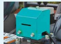
Die Maschine ist optional mit Fahr-Warnton ausgestattet.
