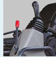
Der Sicherheits-Sperrhebel ermöglicht das Ein- und Aussteigen nur dann, wenn die Bedienhebel ausgerückt sind, um versehentliche Bewegungen zu vermeiden.
