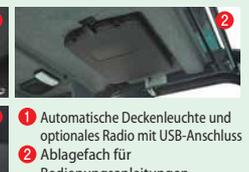
1 Automatische Deckenleuchte und optionales Radio mit USB-Anschluss
