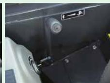
Fahrstufen-Wahlschalter schnell/langsam und Gashebel
