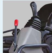
El bloqueo de seguridad de las palancas permite entrar y salir únicamente si las palancas están desengranadas, para evitar un accionamiento accidental.
