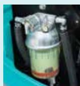
Préfiltere avec décanteur d'eau intégré
