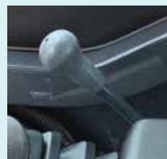
Le levier de lame a une commande hydraulique pilotée pour plus de précision.
