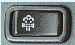
Schalter zur Regeneration des DPF (Dieselpartikelfilter)
