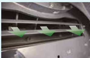
Ein versetzter Luftkanal verlangsamt die Abgase
