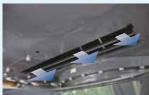
Abgase aus dem Schalldämpfer und dem Motorkühlungslüfter
