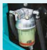
Kraftstoffvorfilter mit eingebautem Wasserabscheider
