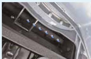
Löcher im Schalldämpfer verteilen die Abgase
