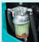
Kraftstoffvorfilter mit eingebautem Wasserabscheider
