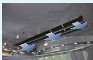
Scarico proveniente da marmitta e ventola di raffreddamento del motore
