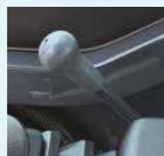
La leva del dozer è dotata di servo-pilota idraulico per una modulazione precisa.
