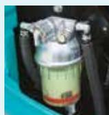
Prefiltro del carburante con separatore d'acqua incorporato
