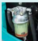
Prefiltro del carburante con separatore d'acqua incorporato
