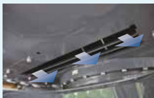
Gases de escape procedentes del silenciador y el ventilador de refrigeración del motor
