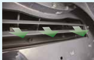
Gases de escape desacelerados por el conducto decalado
