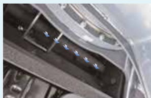
Los orificios del silenciador dispersan los gases de escape
