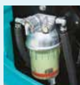
Prefiltro de combustible con separador de agua integrado
