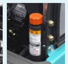
Hydrauliköl mit langer Lebensdauer und einem Wechsellzyklus von 1000 Stunden (Foto zeigt den Hydrauliköl-Einlass)
