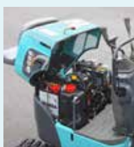
Vollständig öffnende Haube für guten Zugang.
