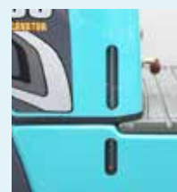
Kraftstofftankanzeige, auf der sich der Kraftstoffstand auf einen Blick ablesen lässt.
