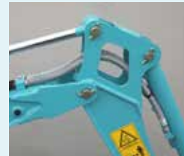
Löffelzylinderschlauch im Stiel
