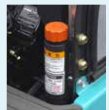
Hydrauliköl mit langer Lebensdauer und einem Wechselzyklus von 1000 Stunden (Foto zeigt den Hydrauliköl-Einlass)
