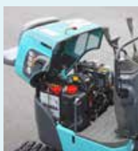
Vollständig öffnende Haube für guten Zugang.
