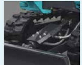
Copertura di protezione del cilindro del dozer
