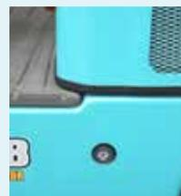
Indicatore sul serbatoio dell'olio idraulico facilmente controllabile.
