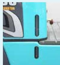
Indicatore sul serbatoio del carburante per l'immediata visibilità del livello di carburante.
