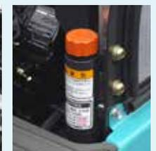
Olio idraulico a lunga durata con ciclo di cambio ogni 1000 ore (la foto mostra l'apertura di riempimento dell'olio idraulico).
