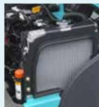
Radiatore in alluminio resistente alla corrosione.
