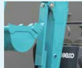
Copertura di protezione del cilindro del braccio di sollevamento
