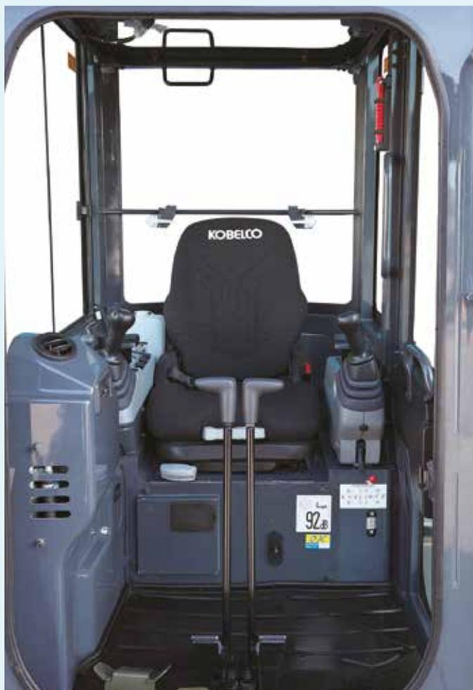
Le vaste plancher associé au siège coulissant offre plus de place pour les jambes des plus grands. Le large siège suspendu et inclinable, ainsi que le positionnement des manipulateurs offrent un confort de travail exceptionnel.
