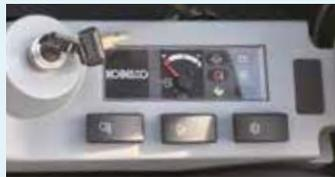
Nouvelle console avec rétroéclairage par LED
