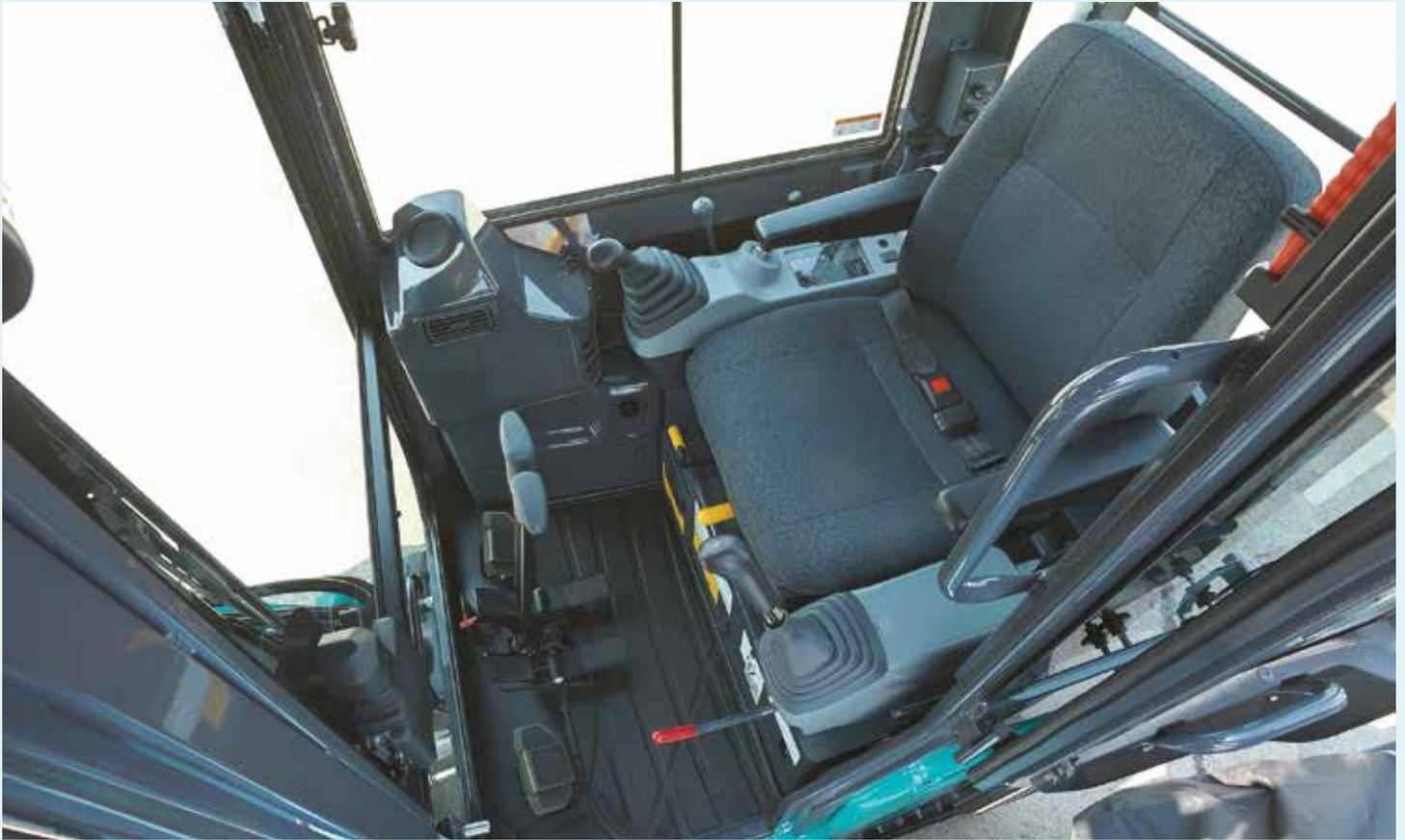
Der größere Fußraum sorgt für mehr Beinfreiheit des Fahrers. Breiterer Arbeitsraum mit mehr Platz zwischen den linken und rechten Bedienhebeln.
