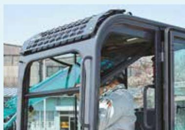
Il parabrezza anteriore è dotato di sospensioni con molle a gas per agevolare e rendere più regolare il movimento di apertura e chiusura.
