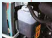
Serbatoio del troppo-pieno del radiatore
