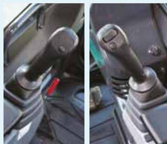
Palanca manual de control proporcional conductos para martillo y cizalla (opcional)
