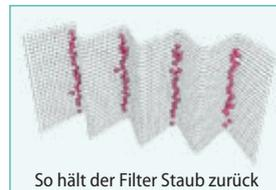
\* 30er-Maschen bedeutet, dass durch horizontale und vertikale Drähte 30 Öffnungen pro Quadrat-Zoll (6,45 Quadratzentimeter) des Filters gebildet werden.
