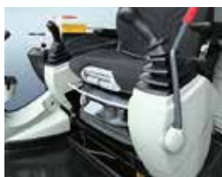
Stoel met luchtvering absorbeert vibratie
