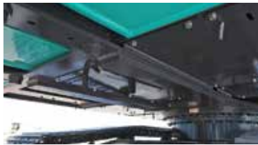
Het frame wordt in de fabriek versterkt ter ondersteuning van het zwaardere contragewicht.
