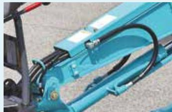
Cubierta protectora para las mangueras detrás del balancín.
