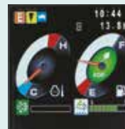
Affichage des niveaux : t°, carburant, DPF, AdBlue
