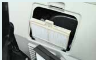
Les filtres de climatisation interne et externe peuvent être démontés facilement sans outil pour le nettoyage.
