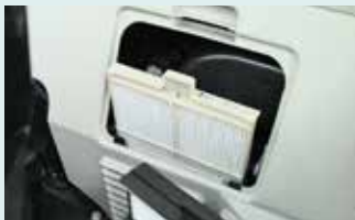
Klimaanlagenfilter können einfach und ohne Werkzeug zur Reinigung entnommen werden. Einer für Außenluft und einer für Innenluft.
