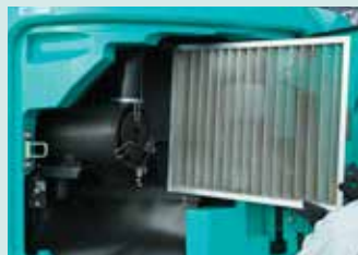
Filtre INDr/vase d'expansion du radiateur/ filtre à air
