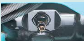
Vanne de vidange rapide d'huile moteur utilisable sans outil.
