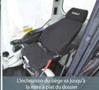
L'inclinaison du siège va jusqu'à la mise à plat du dossier
