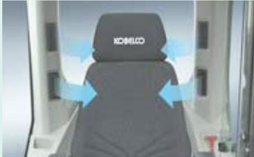
Die große Klimaanlage verfügt über Lüftungsauslässe an den hinteren Säulen, die für eine Belüftung von hinten sowie rechts und links neben dem Fahrersitz sorgen. Sie können so eingestellt werden, dass sie einen Kalt-/Warmluftstrom direkt zum Fahrer leiten, was für eine bequemere Arbeitsumgebung sorgt.
