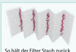
So hält der Filter Staub zurück
