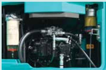
Filtro del carburante con separatore dell'acqua integrato
