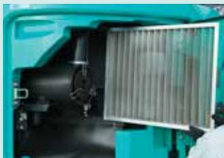
Filtro INDr /serbatoio del radiatore / filtro dell'aria
