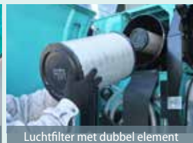
Luchtfilter met dubbel element
