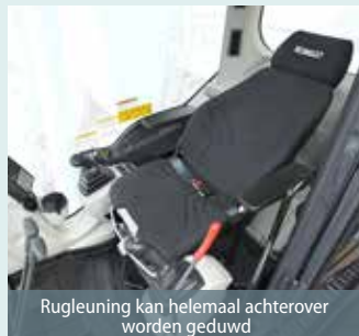
Door de dubbele geleiders kan de stoel geheel naar wens worden versteld
