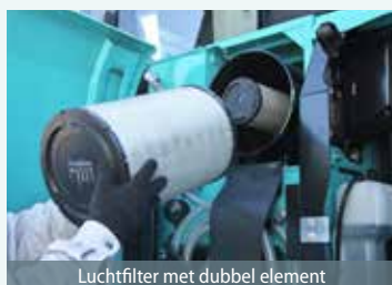
Luchtfilter met dubbel element
