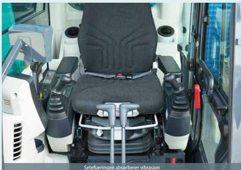
Setefjæringen absorberer vibrasjon
