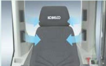
El gran acondicionador de aire tiene registros en las columnas traseras que envían el aire desde detrás y hacia la derecha y la izquierda del asiento del operador. Se pueden ajustar para que el flujo de aire caliente o frío vaya directamente hacia el operador, para que disfrute de un ambiente operativo más cómodo.
