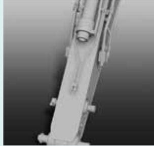
Opcionalmente se dispone de una tubería hidráulica de enganche rápido que acelera los cambios de implemento.
