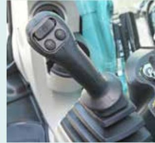
El accionamiento de la palanca de funcionamiento exige un 25 % menos de esfuerzo, lo que reduce la fatiga en las operaciones largas o continuadas.
