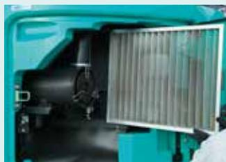
Filtro iNDr/depósito del radiador/depurador de aire
