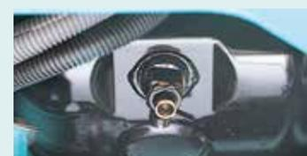
La válvula de vaciado rápido del aceite del motor puede accionarse sin ninguna herramienta.
