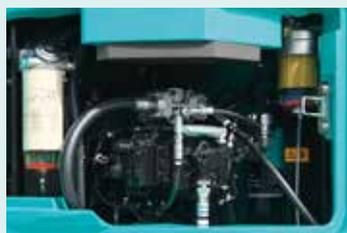
Filtro de combustible con separador de agua integrado
