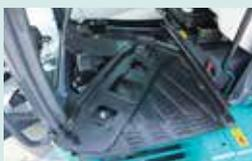
Le tapis de sol amovible en deux éléments a des poignées pour faciliter sa dépose. Les bords relevés du tapis de sol piègent les poussières et le sable pour faciliter le nettoyage.
