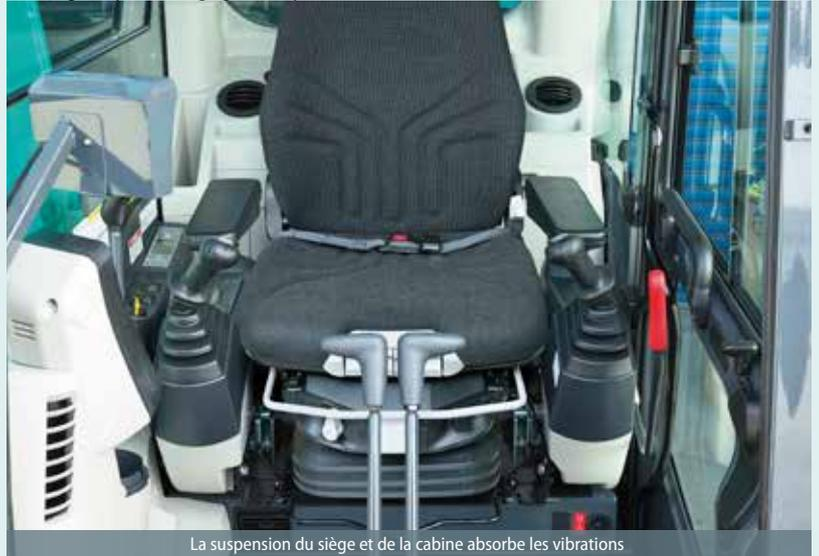
La suspension du siège et de la cabine absorbe les vibrations
