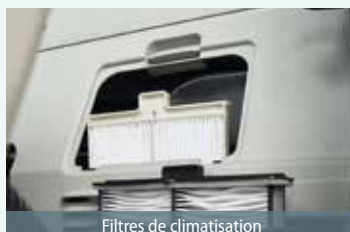
Filtres de climatisation
