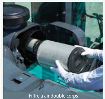
Filtre à air double corps
