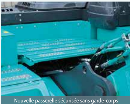
Nouvelle passerelle sécurisée sans garde-corps
