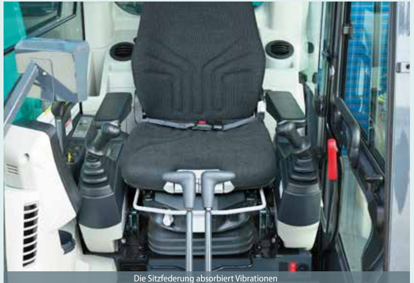
Die Sitzfederung absorbiert Vibrationen
