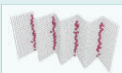
So hält der Filter Staub zurück
