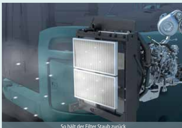
So hält der Filter Staub zurück
