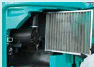
iNDR-Filter / Kühlmittelbehälter / Luftfilter
