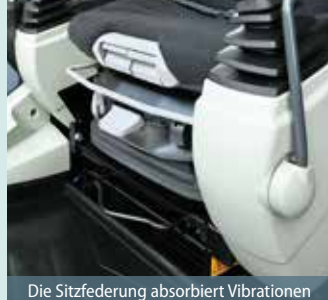
Die Sitzfederung absorbiert Vibrationen
