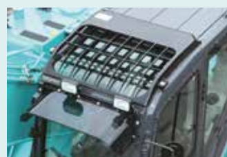
La protezione del tettuccio (livello II) è una dotazione standard.
