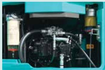
Filtro del carburante con separatore dell'acqua integrato
