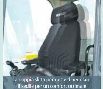
La doppia slitta permette di regolare il sedile per un comfort ottimale
