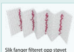
Slik fanger filteret opp støvet
