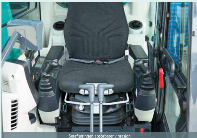
Setefjæringen absorberer vibrasjon
