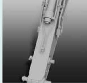
Se dispone como estándar de una tubería hidráulica de enganche rápido que acelera los cambios de implemento.
