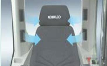
El gran acondicionador de aire tiene registros en las columnas traseras que envían el aire desde detrás y hacia la derecha y la izquierda del asiento del operador. Se pueden ajustar para que el flujo de aire caliente o frío vaya directamente hacia el operador, para que disfrute de un ambiente operativo más cómodo.
