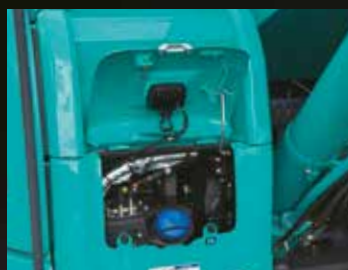
Depósito de DEF a nivel del suelo
