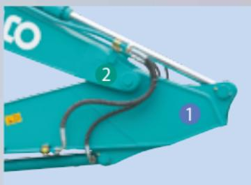
L'articulation d'équipement a été renforcée pour absorber un volume de travail intense, une puissance hydraulique accrue, tout en assurant une excellente durabilité dans les conditions de travail les plus exigeantes.
