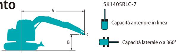
A - Raggio dall'asse di rotazione alla parte superiore del braccio di scavo
