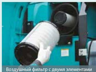
Воздушный фильтр с двумя элементами
