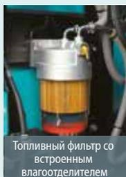
Топливный фильтр со встроенным влагоотделителем
