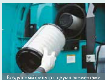
Воздушный фильтр с двумя элементами
