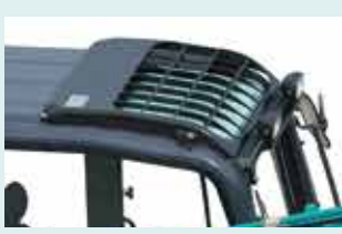
Защита потолочного стекла устанавливается по отдельному заказу (ISO 10262:1998).
