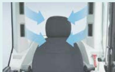
Дефлекторы большого кондиционера воздуха расположены позади сиденья оператора и обдувают сиденье и области по бокам от него. С их помощью можно направить прямой поток прохладного или теплого воздуха на оператора, что позволяет создать комфортную рабочую среду.
