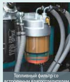
Топливный фильтр со встроенным влагоотделителем
